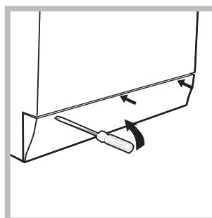
1. снимите переднюю панель стиральной машины при помощи отвертки (см. схему);
